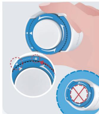
**UPOZORNENIE:** Po úplnom uvoľnení bezpečnostného spínača nestláčajte biele tlačidlo v strede, aby ste predišli neúmyselným výsledkom alebo zraniu
